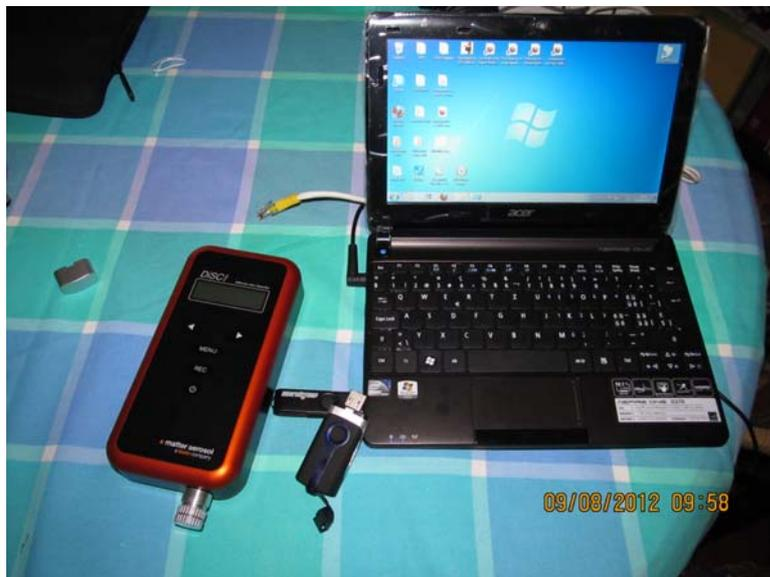
La foto sopra mostra i tre strumenti usati da OKKIO per eseguire la campagna di misurazione delle Nanoparticelle.
